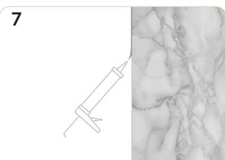
Dopo l'applicazione, è necessario sigillare i bordi con del silicone per evitare che entri l'umidità.
